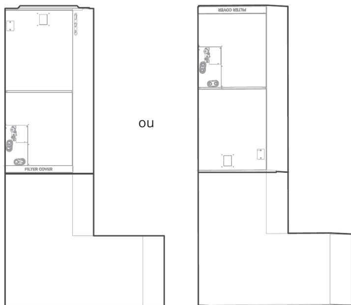
**Instructions de montage :** En cas d'installation verticale (flux ascendant ou flux descendant), l'extrémité inférieure de la sortie d'air doit être raccordée au conduit d'air métallique en forme de L et fixée à l'aide de vis. Si l'air de retour doit être canalisé, installez le conduit au ras du sol. Posez l'unité sur le sol au-dessus de l'ouverture. Tout l'air de retour doit passer par le serpentin.
