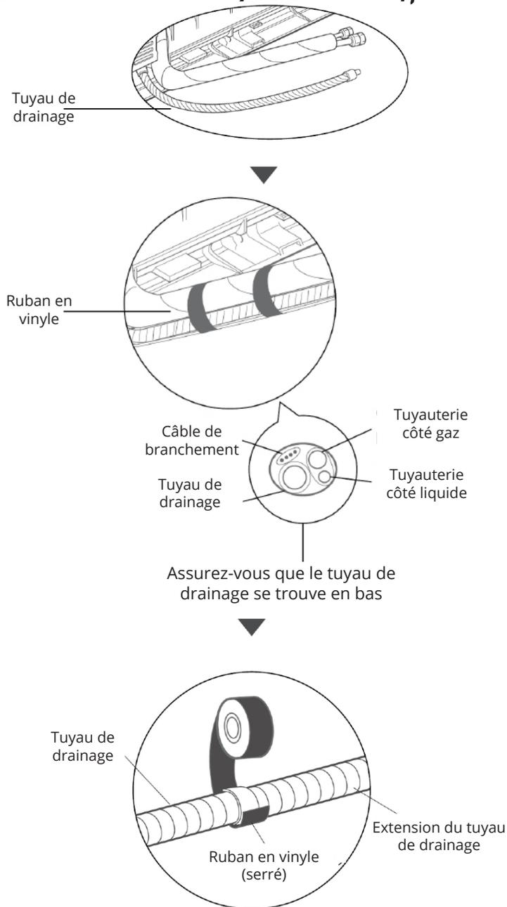
Le tuyau de drainage peut être fixé sur le côté gauche ou droit. Pour assurer un bon drainage, fixez le tuyau de drainage du même côté par lequel la tuyauterie de réfrigérant sort de l'unité. Fixez une extension de tuyau de drainage (à acheter séparément) à l'extrémité du tuyau de drainage.
