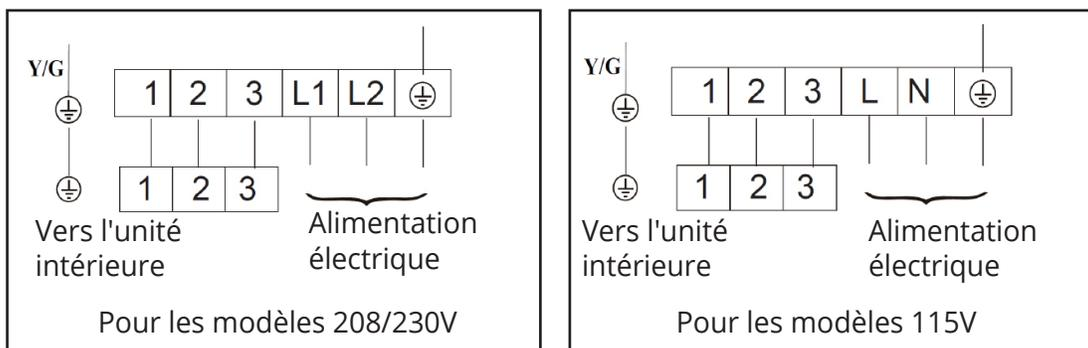
**Le bornier de l'unité extérieure est protégé par un couvercle de câblage électrique situé sur le côté de l'unité. Un schéma de câblage complet est imprimé à l'intérieur du couvercle.**
