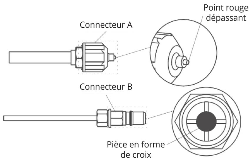
1. Avant d'effectuer le raccordement de la tuyauterie de réfrigérant, portez toujours des gants et des lunettes de travail, et rappelez-vous que les connecteurs A et B ne doivent pas être orientés directement vers les personnes.
