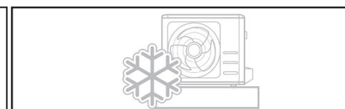
☑ Lorsque des chutes de neige sont prévues, prenez les mesures nécessaires pour éviter l'accumulation de glace et l'endommagement des serpentins.
