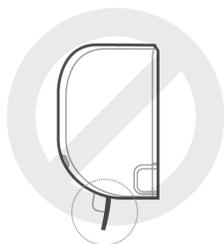
En mode COOL ou HEAT, un angle trop faible de la persienne peut réduire les performances de l'unité en raison d'un flux d'air restreint.
