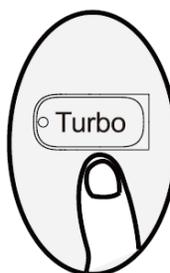
Lorsque la fonction Turbo est activée en mode COOL, l'unité souffle de l'air frais avec le réglage de ventilation le plus fort pour relancer le processus de climatisation.
